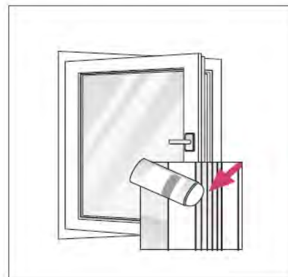
Manutenção das juntas
