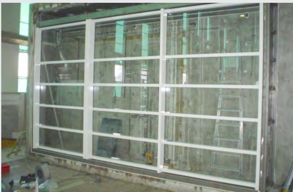
Figura 1: Protótipo de uma fachada sujeita a ensaio em laboratório notificado.
